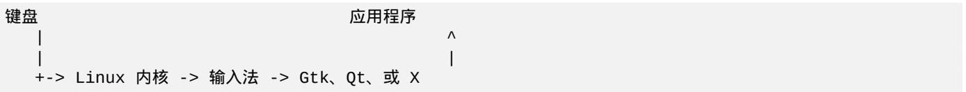
通过 `im-config` 使用 IBus 家族的软件包可以简单地为 Debian 系统建立多语种的输入。下面列出了一些 IBus 软件包。
